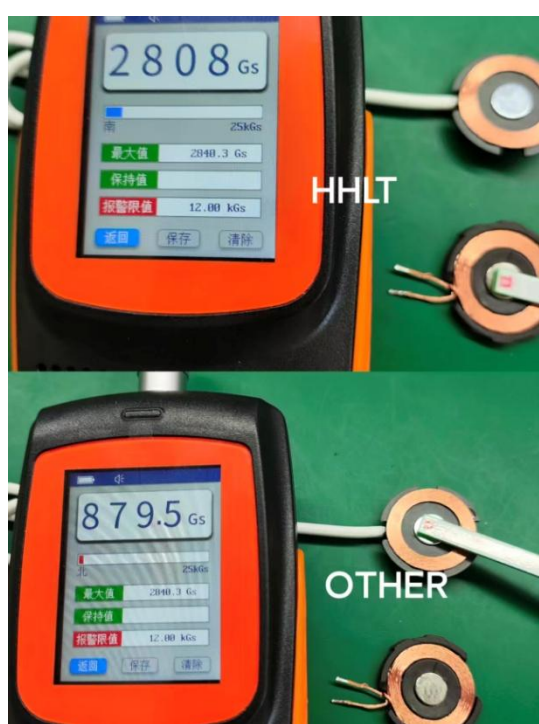
Other 线圈用的磁铁是 880GS 的低标号磁铁，吸力弱，HHLT 线圈用的是 2800GS 的高标号磁铁，吸力强；实验
